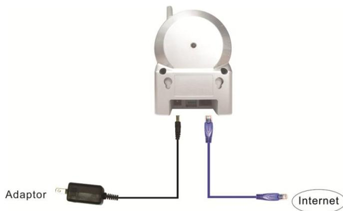
图 2-3：网络摄像机连接图。
